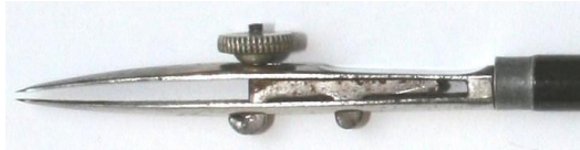
afb. 4b – schuifje naar links, trekpen gesloten
