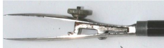
afb. 4c – schuifje naar rechts, trekpen geopend
