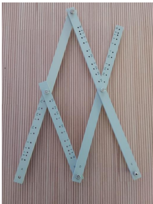
Fig. 1. Een pantograaf, ingesteld op de vergrotingsfactor 2.
