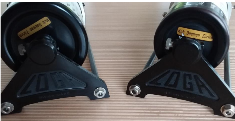
Fig. 2. De bakelieten zijsteunen van het onderstel van de LOGA 7,5 m en 2,4 m rekenwalsen.
