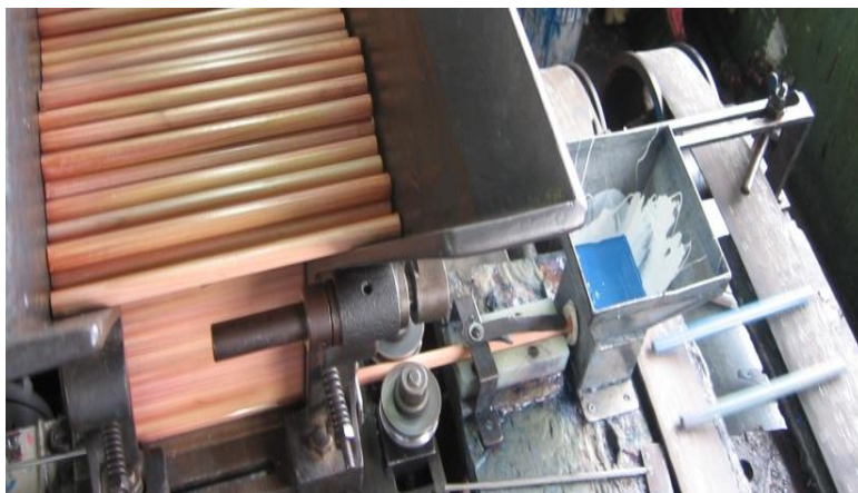
Fig. 3. Elk potlood uit de container gaat door de verfstraat.
