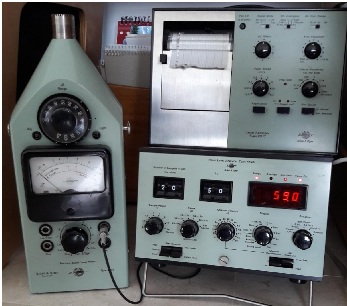
Afbeelding 3: De meetconfiguratie. Op de B&K-4426 is in de display het 'bijna-momentane' equivalente geluidsniveau als LA_{eq} van 59,0 dB af te lezen. Met de draaischakelaars van afbeelding 1, zijn de verschillende waarden en statistische uitkomsten van de meting in te stellen en af te lezen van de display.
