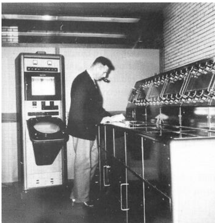
Fig. 1. Fourier-synthesizer van Hammer, waarmee een antenne-array kon worden gesimuleerd.
