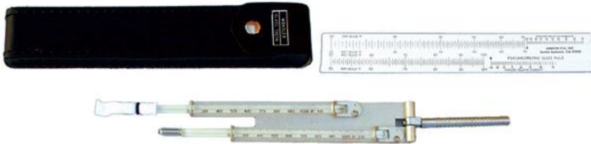
Fig. 20. De Taylor sling psychrometer slide rule.
