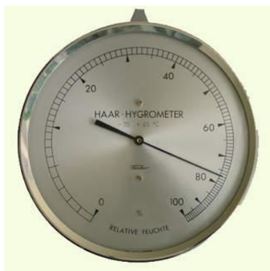
Fig. 1. Een hygrometer met een haar als vochtigheidsdetector.
