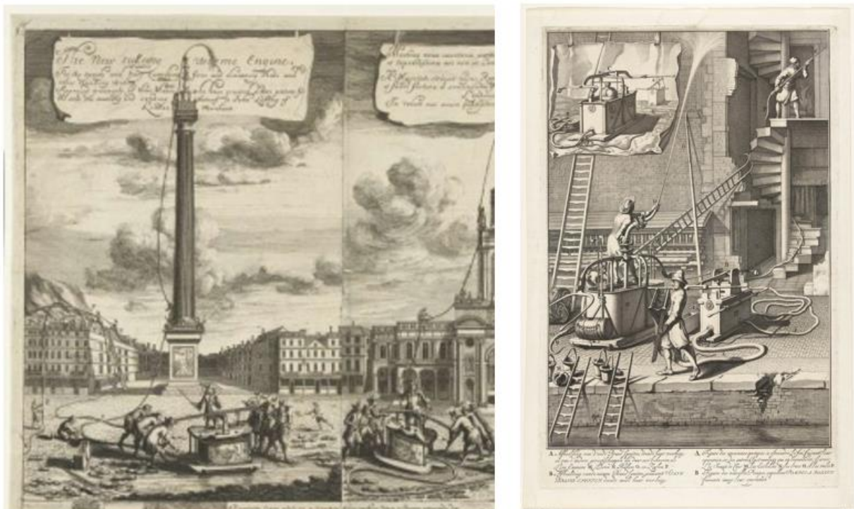
Fig. 9. 17 e -Eeuwse afbeeldingen van brandweerpomp en –slangen naar ontwerp van Jan van der Heijden.
