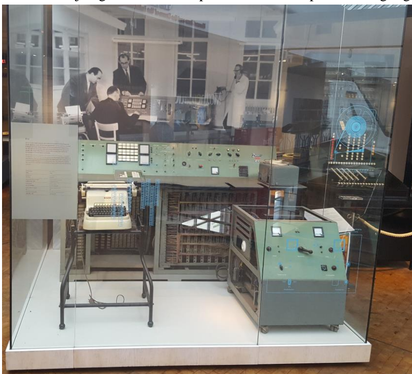
Fig. 3. De Z-11 uit 1956, een digitale, elektromechanische computer, (met relais) gebouwd door Konrad Zuse KG, Deutsches Technikmuseum, Berlijn, september 2017
