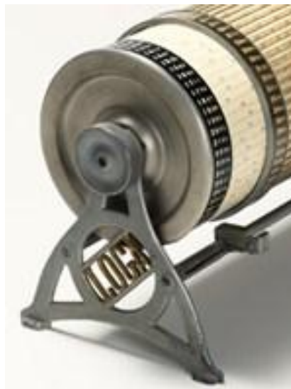
Opengewerkte letters LOGA in de zijkanten van het onderstel van de 15 m rekenwalsen.
