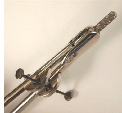
Figuur 4a/b. AFA passerdoos met opzetstukje voor fijninstelling
