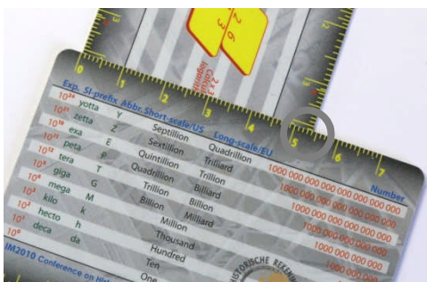
Meting van de hoogte van de onderliggende N-card: 5,4 cm.
