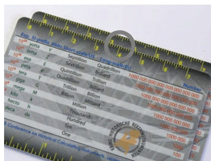
Meting (a) van de breedte van de onderliggende N-card, van de linkerzijde tot de middelschaalwaarde 3,5: 4,0 cm.
