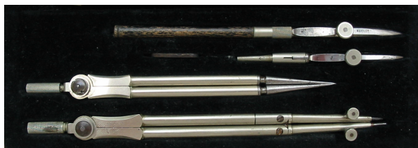
Figuur 5.8: Passerdoos met systeem Riefler van Kern, 294 x 80 mm
